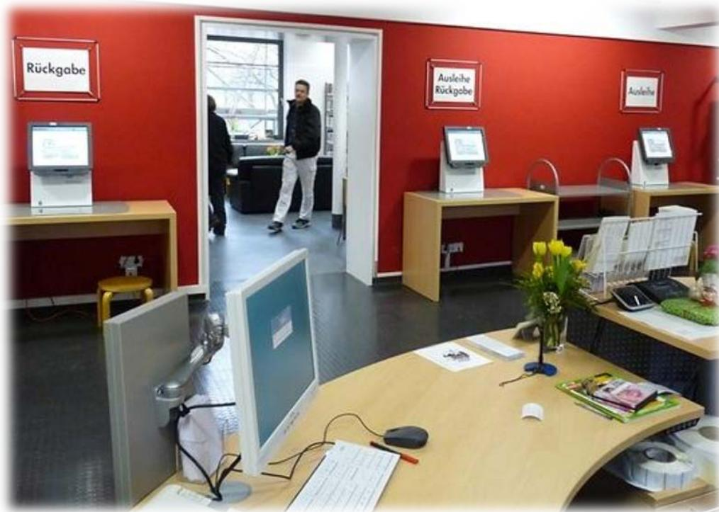
Selbstverbucherplätze frei in Art und Ausführung, kratzfeste und strapazierfähige Oberfläche Schichtstoff HPL, mit Ausschnitt in der Tischplatte, integrierter Rechner, Kabeldurchlass und kompletter Kabelführung.
