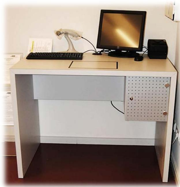
Selbstverbucherplatz mit Ausschnitt in der Tischplatte, Schichtstoff belegt (HPL), Rechneraufnahme, Kabeldurchlass und kompletter Kabelführung.
